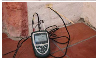
Messung der Oberflächenfeuchtigkeit (oben) und der relativen Luftfeuchtigkeit in den Bohrlöchern (unten).
